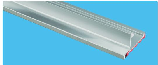
ステンガード部は、ステンレスによるケガを防止する為に、定尺より両端0.5mm程度短くしています。
