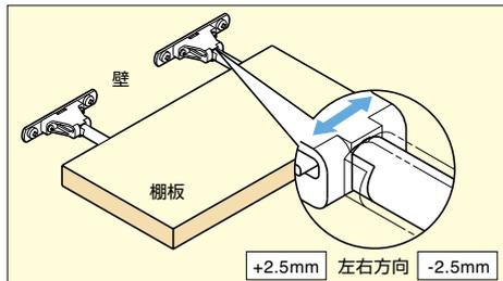
棚受の支持ピン（丸棒部分）が左右にスライドします。支持ピンを加工穴の位置に合わせ、棚板を差し込みます。
