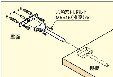
壁に棚受を固定した後、棚板を取り付けます。
