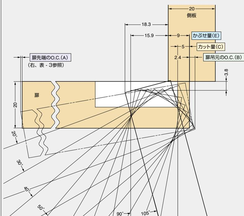
本図はカット量5mm、扉厚20mm、側板厚20mmで9mmかぶせ仕様です。
