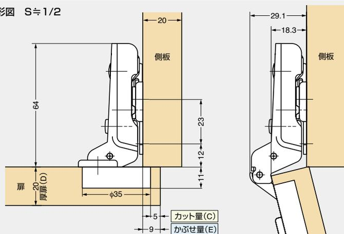
本図はカット量5mm、扉厚20mm、9mmかぶせ仕様で、230-U26/9Tとマウンティングプレート 230-P4W-30T (別売) の組み合わせです。
