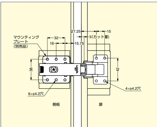
本図はカット量5mm、扉厚30mm、側板厚15mm、13.6mmかぶせ仕様の取付位置です。
