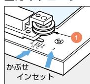
側板と扉のかぶせ面に合わせ、ガイドローラー<sup>1</sup>を取り付けます。
