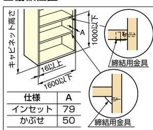
キャビネット高さが1000mmを超える場合は、最大間隔1000mmごとに、締結用金具で固定した棚を設けてください。
