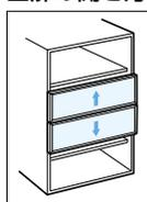
片側扉を操作すると、2枚の扉が運動して上下に開閉します。
