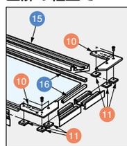
アルミフレーム<sup>15</sup>の溝にコーナー金具取付プレート<sup>11</sup>を差し込みコーナー金具<sup>10</sup>と取付穴を合わせ固定します。
