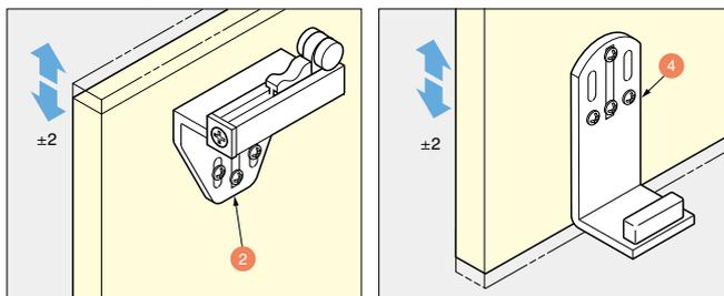
扉の高さは-2mmから+2mmの範囲で調整できます。ローラーハウジング②、ガイド④のねじをゆるめて調整してください。
