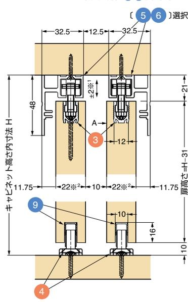
※<sup>2</sup>扉に掘込加工をしてローラー①を取り付け、上レール (幕板付) ⑤⑥に吊り込む場合は、扉厚を22mmに限定してください。
