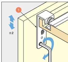
ローラー(1)の六角穴を六角棒スパナで回して、扉の高さを-2mmから+2mmの範囲で調整できます。
