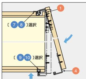
天板の上レール(7, 8)にローラー(1)のをせ、ガイドレール(9, 10)にガイドローラー(4)を入れて調整するだけで簡単に取り付けできます。
