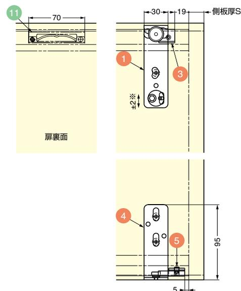
※扉の高さは-2mmから+2mmの範囲で調整可能。詳細は上図「■扉の高さ調整」をご覧ください。
