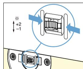
ローラー①のダイヤルを回して高さ調整ができます。
