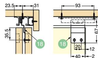
※<sup>2</sup> 扉の高さは-3mmから+3mmの範囲で調整可能。ローラー①の六角部を六角棒スパナで回して高さを調整してください。
