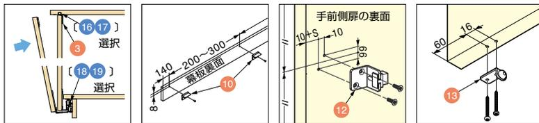
扉をレール<sup>18</sup><sup>19</sup>に吊り込みガイドレール<sup>16</sup><sup>17</sup>に入れ、ガイドローラー<sup>3</sup>がはずれないようにブッシュ<sup>11</sup>をはめ込んでください。
