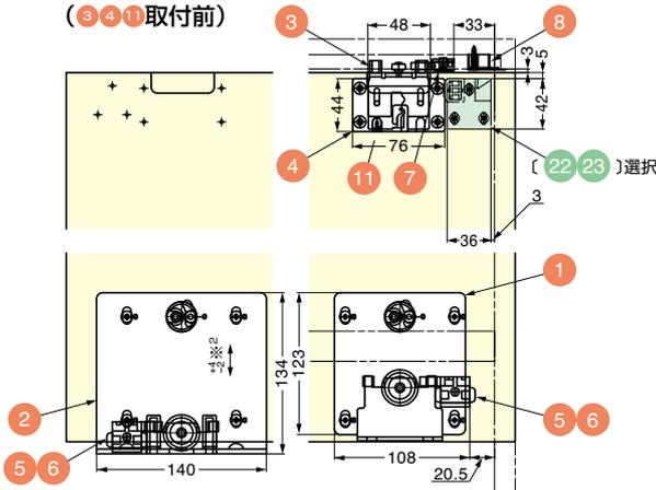
※<sup>2</sup> 扉の高さは-2mmから+4mmの範囲で調整可能。ローラー<sup>1</sup><sup>2</sup>の六角部を六角棒スパナで回して高さを調整します。
