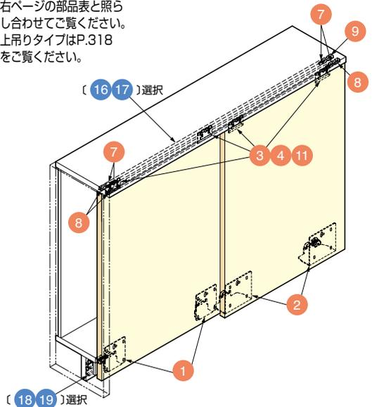
扉の吊り込みが簡単。最大扉高さ2400mmまで対応できる下荷重タイプの木製引戸金物。
