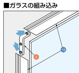
アルミフレーム15は、四隅のコーナー金具1を六角棒スパナで締め込み固定します。
