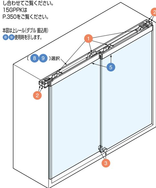
ガラス上部をアルミフレームに接着して、ガラス加工を不要にした引戸金物。
