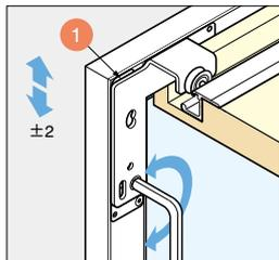
ローラー①の六角穴を六角棒スパナで回して、-2mmから+2mmの範囲で調整できます。
