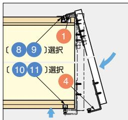
天板のレール〔8 9〕にローラー①をのせ、ガイドレール〔10 11〕にガイドローラー④を入れて調節するだけで簡単に取り付けることができます。
