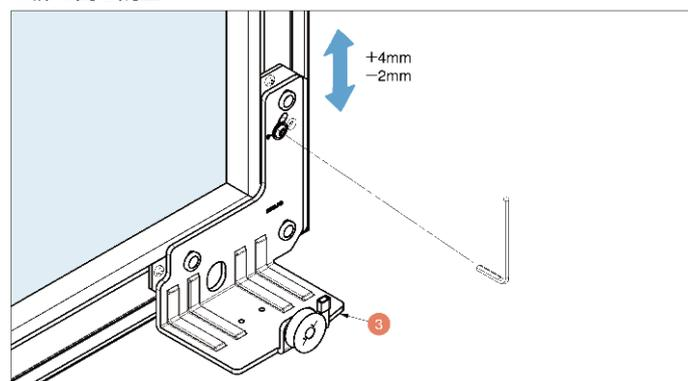
ローラー(1)～(4)を六角棒スパナで回して扉の高さを-2mmから+4mmの範囲で調整できます。
