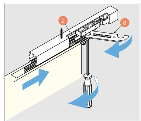
ハンガーパーツ②のハンガーボルトを、アジャストレンチ⑧またはマイナスドライバーで回して、扉の高さを調整してください。
