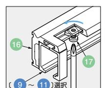
**■エンドキャップ (壁固定プロファイル用) ⑬の取り付け**
