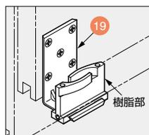
調整式下ガイド19の樹脂部は、扉厚に合わせて調整します。
