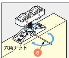
六角ナットを緩めた後、ハンガーボルトの穴にアジャスタピンを差し込み回転させ、調整します。
