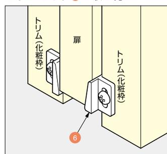
ドアガイド⑥の取付位置を上下にずらして、扉とのすき間を調整できます。図のように扉下端の仕上材の両側に取り付け、扉が軽く動き、がたが小さくなるよう調整してください。
