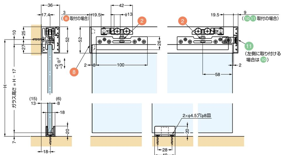
※<sup>2</sup>扉の高さは-3mmから+2mmの範囲で調整可能。ハンガーボルト⑨をスパナで回して高さ調整をしてください。
