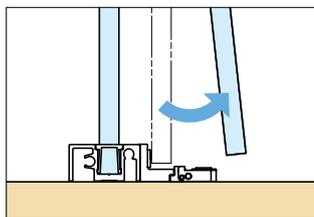
下ガイド⑥の片側を倒してガラス扉を手前に傾けることができるため、ガラス扉と固定ガラスの隙間が掃除しやすいです。
