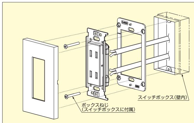
ブラケットにプレートを押し込むことで、簡単に取り付けできます。
