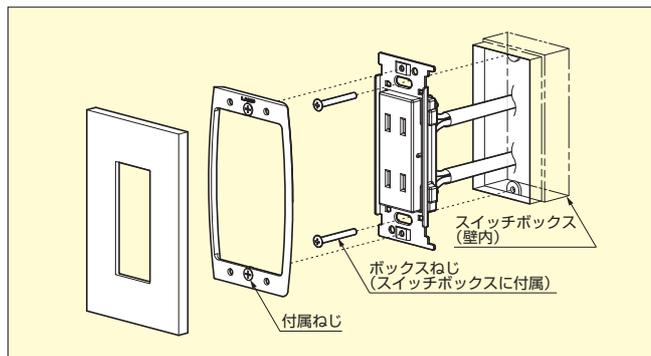
付属ねじで固定したブラケットにプレートを押し込むことで簡単に取付ができます。
