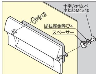
付属のスペーサー、ばね座金、小ねじで、取付パネルを挟み込むように取り付けます。
